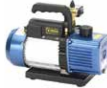
Pompa Vakum VRV - TAS0090 Type Rotor : 2 Tahap Kapasitas pemindahan : 9.5CFM (270L/Mnt) Kekuatan Vakum : 12 Micron (220V, 200W) Putaran per menit : 3.440 Rpm Kapasitas Oli : 570 ml Ukuran : 38 x 16 x 28,5 cm (14,8 Kg) – termasuk adapter (1/4 & 5/16)
