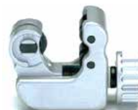
Pemotong pipa untuk ukuran kecil yang sangat praktis
